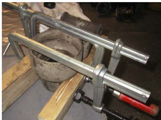
Montering for utpressing av aksel.
