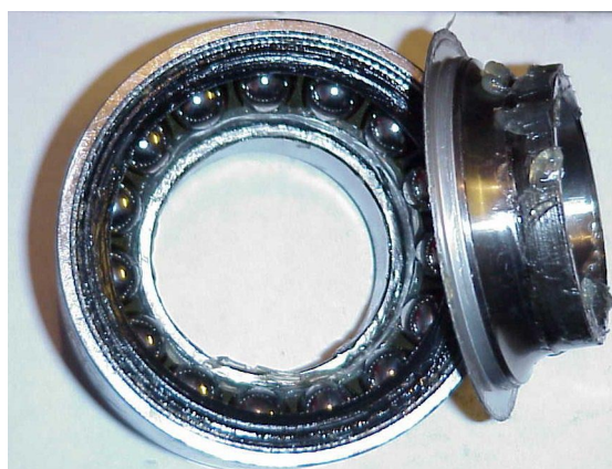
Här var det fullt! Man kan få in mycket fler kulor i den här lagertypen än i ett vanligt spårkullager. Lagerbanorna går som synes mycket långt upp på sidorna vilket är bra.
