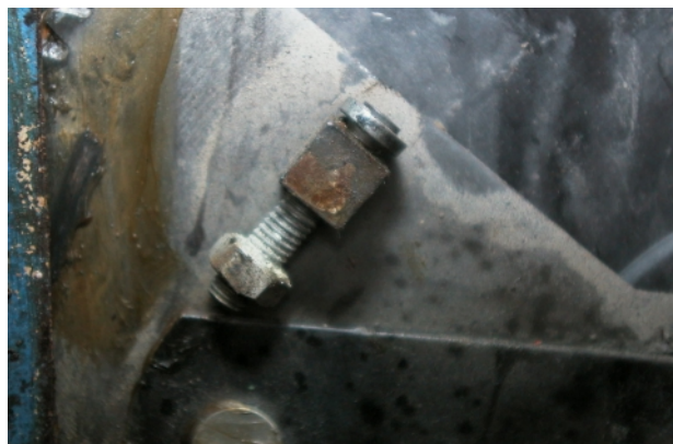
Sänk armen tills stoppskruven är åtkomlig, justera för att möjliggöra större armrörelse.
