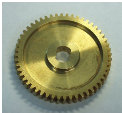
Mässingsdrevet som ersätter det spröda plast-dito. Lägg märke till det knepiga hålet som ej kan fräsas utan behöver en brotsch.
