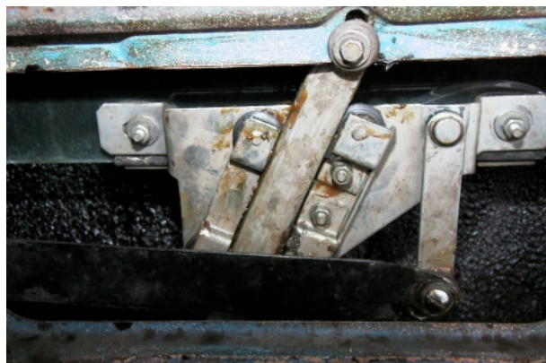
Första angreppspunkten. Rutans styrskena måste bort och för att få loss den måste rutan frigöras från skenan. Rutan sänks en aning för att man skall komma åt båda muttrarna.
