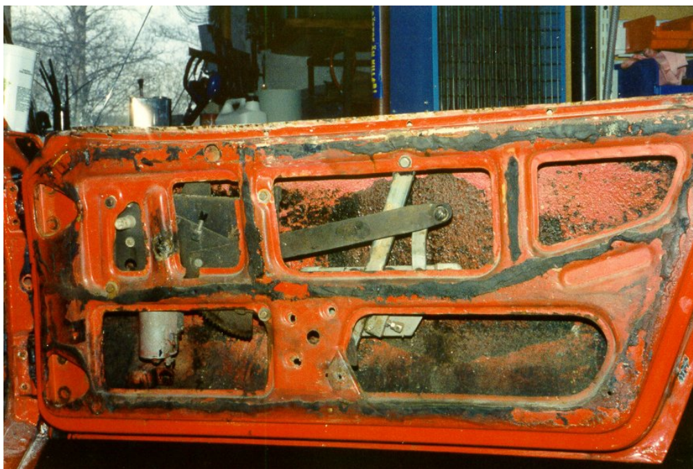
Så här brukar det ofta se ut när dörrsidan lyfts bort första gången. Smutsigt värre och diverse tätningsmedel överallt. Passa på och gör en ordentlig rotskyddsbehandling.
