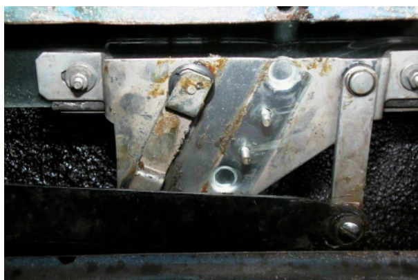
Ingenting här, ingenting där, borta! Lossa nu armen från rutan och fäst rutan i rutramen.
