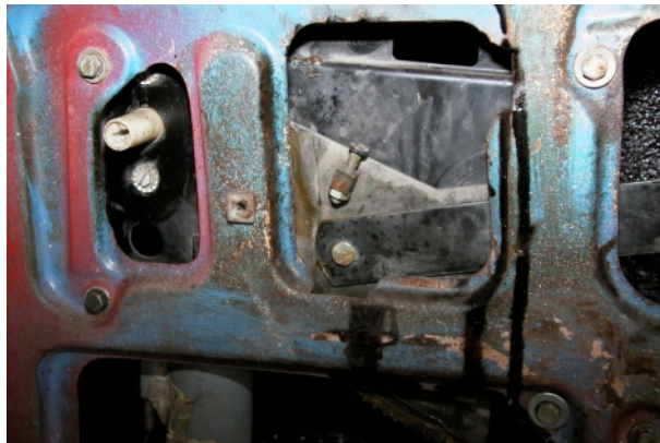
Mekanismen hålls fast av fyra skruvar.
